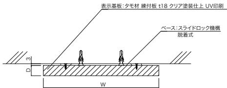
表示基板:タモ材 練付板 t18 クリア塗装仕上 UV印刷
