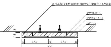
表示基板:タモ材 練付板 t18クリア 塗装仕上 UV印刷
